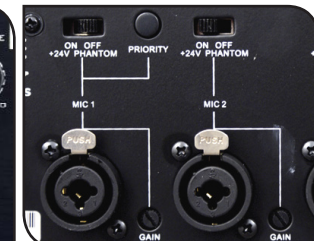
Alimentation phantom sélectionnable Selectable phantom power
